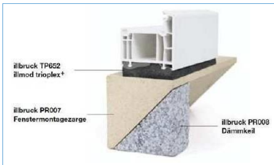
Abb.11a. Montage eines Fensters in der Wärmedämmschicht
