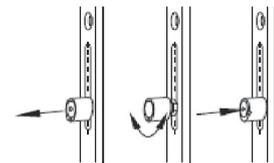
Manuale Einstellung des Anpressdruckes des Flügels zum Rahmen dank Rastexcenter. Um des Anpressrucks einzustellen, bitte die Rolle ziehen und in entsprechender Stellung drehen (Einstellung in Bereich +/- 0,8 mm).
