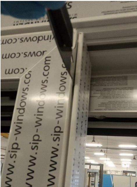
Abb.... Demontage der Frontschieberabdeckung.
