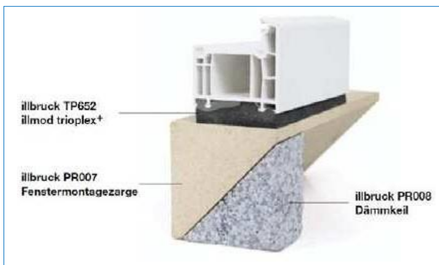
Rys.11a. Montaż okna w warstwie ocieplenia
