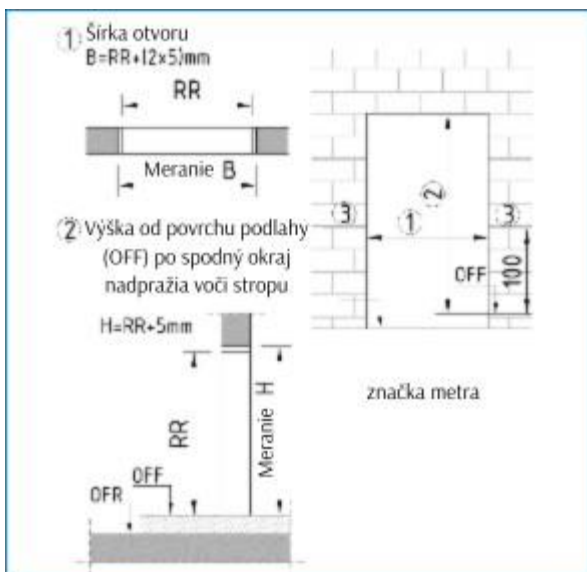
Obr. 3 Spôsob merania okenného otvoru
